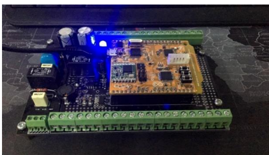
รูปที่ 4.5 การต่อวงจรเพื่อทำการทดลองการทำงานของ RFM95W ของอุปกรณ์สถานีฐาน
