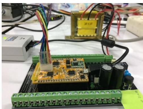
รูปที่ 4.3 การต่อวงจรเพื่อทำการทดลองการทำงานของระบบบลูทูธของอุปกรณ์สถานีฐาน
