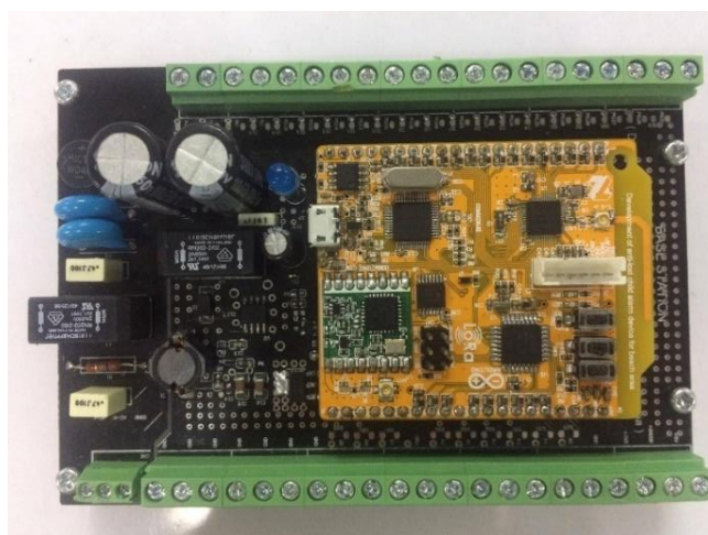
รูปที่ 3.19 การออกแบบฮาร์ดแวร์ของอุปกรณ์สถานีฐาน
