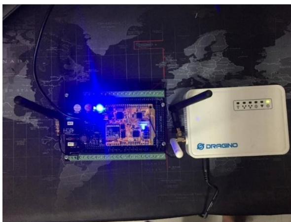
รูปที่ 4.9 การทดลองการรับส่งข้อมูลระหว่างตัวอุปกรณ์สถานีฐานกับอุปกรณ์เกตเวย์
