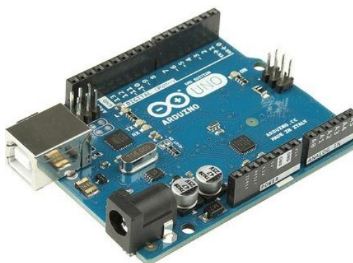
รูปที่ 3.13 Arduino UNO (Arduino, 2017)
